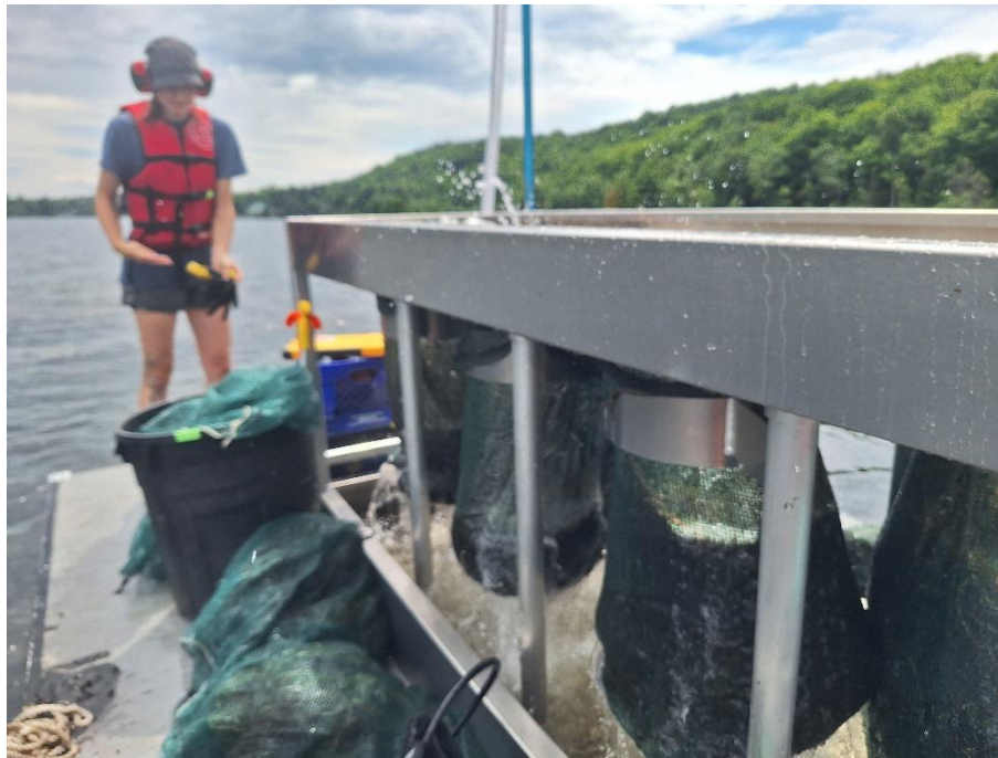
Figure 9 : Table du système de remontée par succion qui permet de remonter le myriophylle à la surface.
